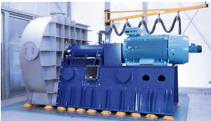
Brüdenverdichtung Foto: Piller Blower & Compressors GmbH
