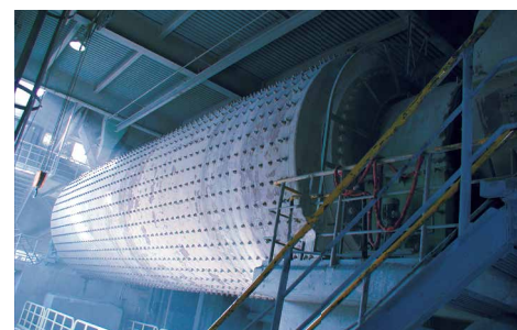
Kugelmühle zur Zementherstellung
