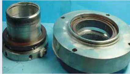
Die PowderAce nach 4 Jahren Einsatz: Nach routinemäßiger Überarbeitung der Gleitflächen konnte die Dichtung wieder eingebaut werden.
