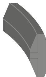
Form SRX oval, mit Bohrung zum Druckausgleich, gem. API 17D
